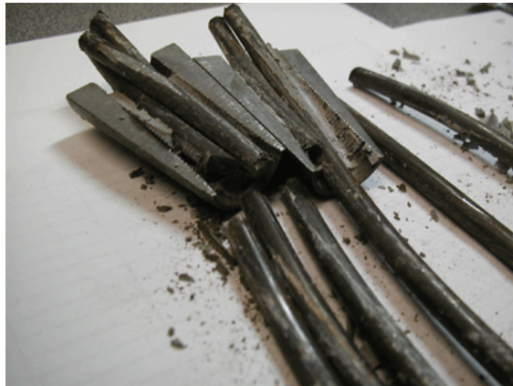
(d) Wire fracture at wedges (Bottom strand)
